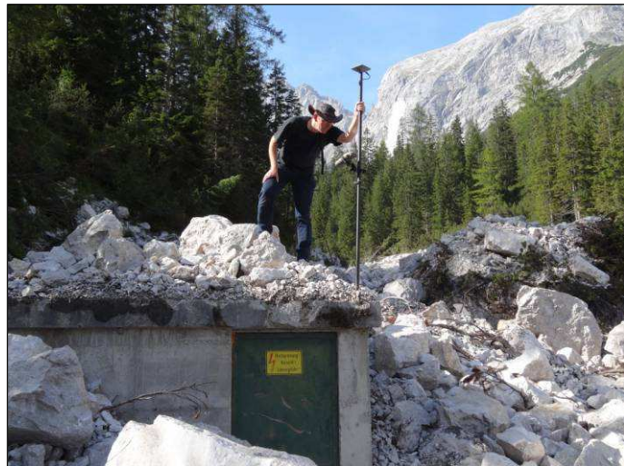
Abb. 2: Einmessen der „Ground Control Points“ – hier am Beispiel eines natürlichen Punktes an der Dachkante des teilweise verschütteten Generatorhauses.
