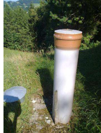
Betonpfeiler als Messpunkt, Gresten
