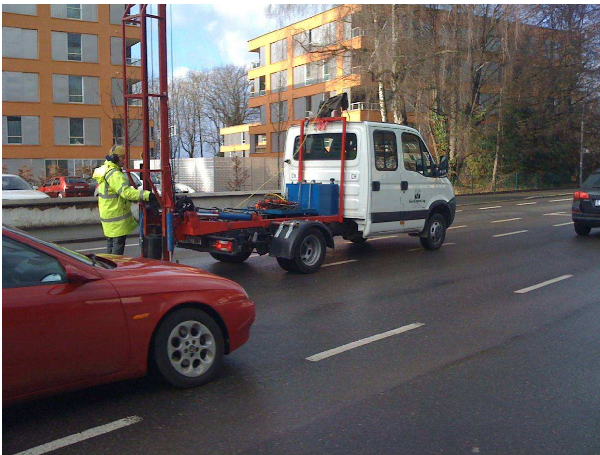
Abb. 2: Fallgewicht im Einsatz auf der stark befahrenen Arlbergstrasse: Ein 360 kg schwerer Stempel schlägt aus 4 m Höhe in freiem Fall auf eine Hartgummiplatte.
