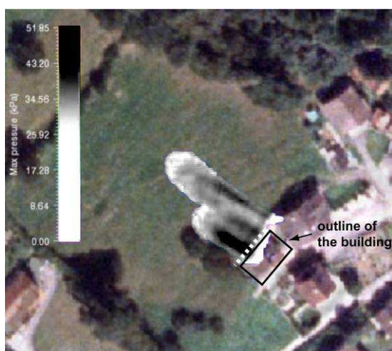
Abb. 2: Maximale Druckverteilung der Hangmure in Alpnachstad (extended Voellmy)
