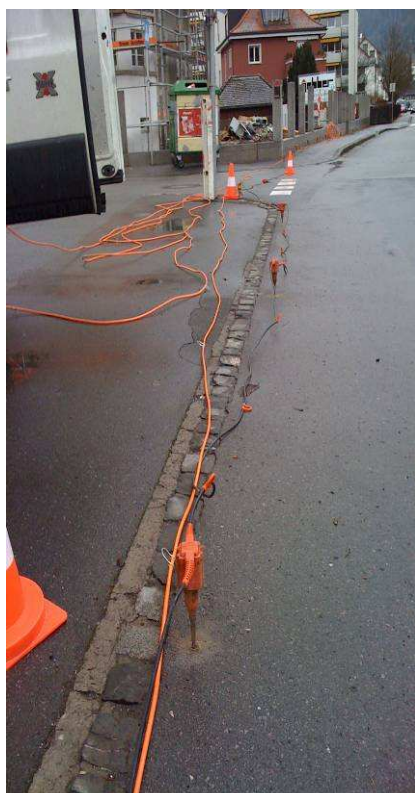
Abb. 2: Fallgewicht im Einsatz auf der stark befahrenen Arlbergstrasse: Ein 360 kg schwerer Stempel schlägt aus 4 m Höhe in freiem Fall auf eine Hartgummiplatte.
