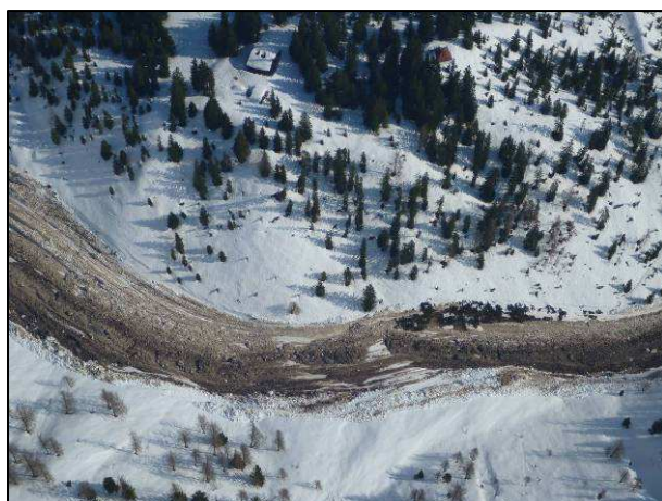
Abb.4. Sturzbahn unterhalb des Alphauses mit deutlichen Rutschstriemen
