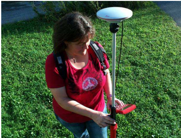
Abb. 4: GPS Vermessung, Rutschung in Scheibbs
