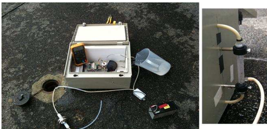
Fig. 2 : Feldeinsatz des Prototypen zur in situ Detektion von chlorierten Kohlenwasserstoffen.
